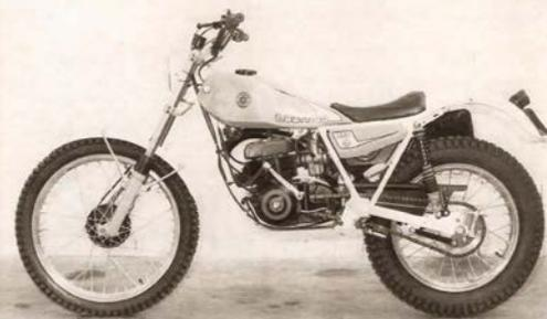
NUEVO CAMBIO, 6 VELOC., CILINDRADA 340 c.c.
